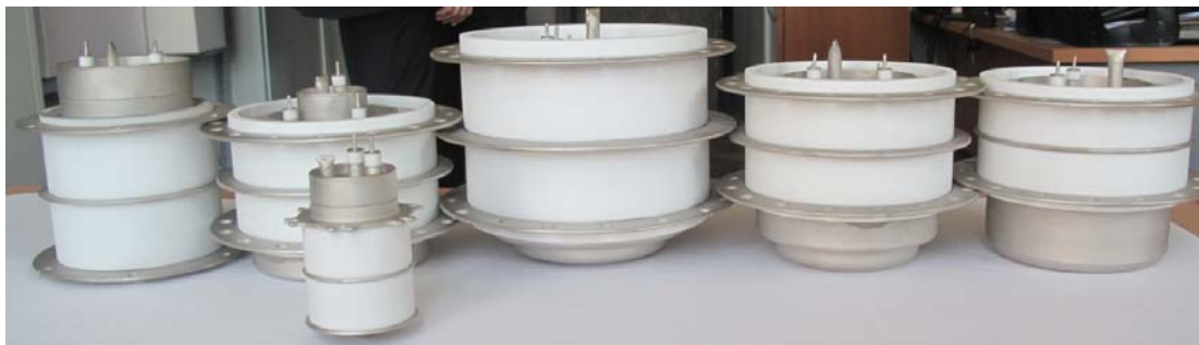
ТДИ-тиратроны производства ООО «Импульсные технологии» на напряжение до 150 кВ и токи до 300 кА.
