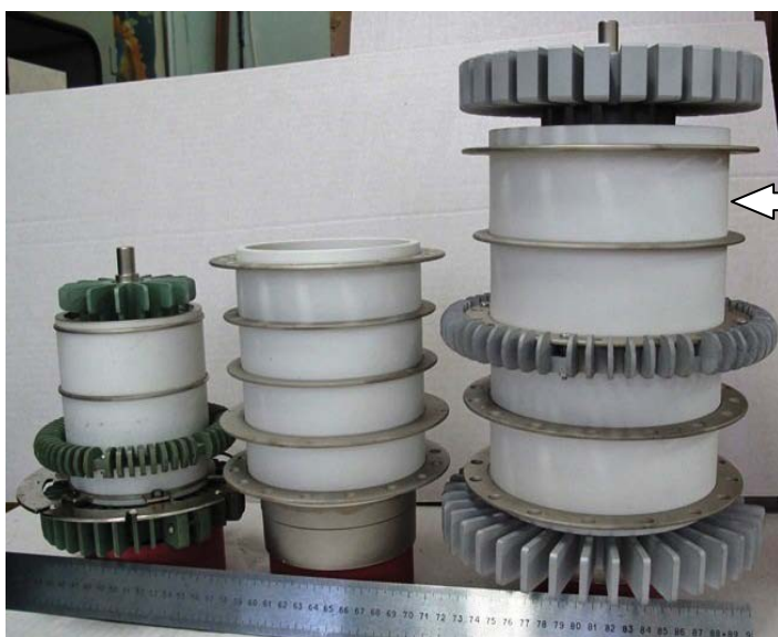
ТГИ-тиратроны на 30, 50 кВ и 75 с комбинированным катодом на среднюю мощность от 150 до 500 кВт
